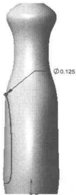
图 2-34 建立穿透关系并标注尺寸
