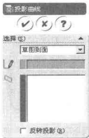
图 2-30 建立“草图到面”的投影曲线
