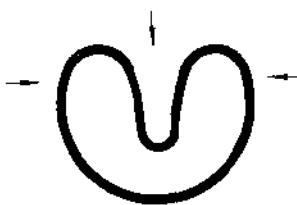
图 26.3-13 同轴密封圈的装配
